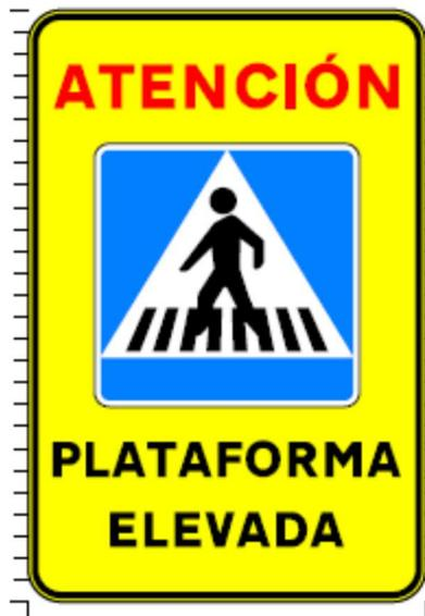
Señal sobre la plataforma elevada, de 600x900 mm reflectante DG (nivel III) Amarillo limón, con las señales tipo S-13 y texto " PLATAFORMA ELEVADA".
