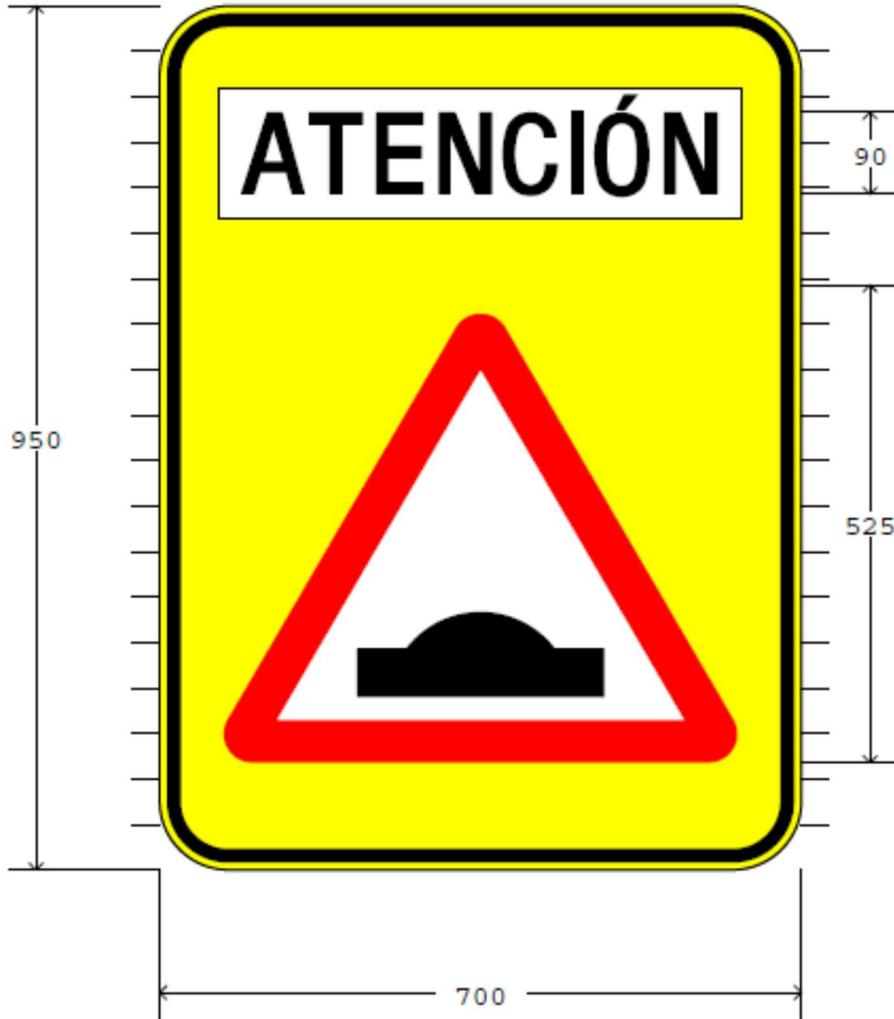
Se utiliza para indicar precaución por la presencia de un resalto en la calzada, ya sea banda de goma o lomo de asco "in situ". Será reflectante nivel III (DG) y fondeada en amarillo limón, con cantos pintados color amarillo.
