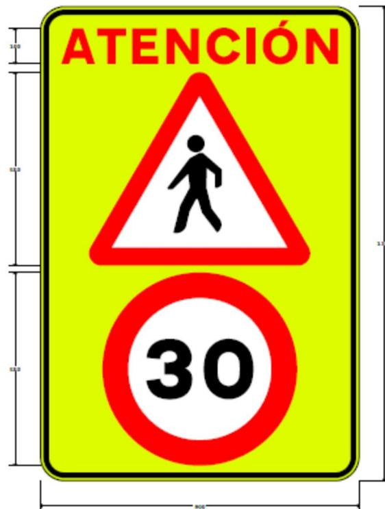
Señal de preaviso PRIMERA de 600x900 mm reflectante DG (nivel III) Amarillo limón, con las señales tipo R-301 (30) y P-20..
