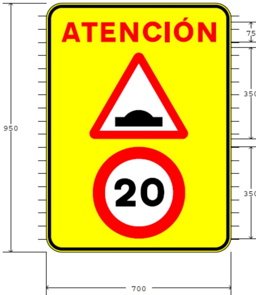
Se utiliza como segundo preaviso de plataforma elevada (la más cercana al elemento) para indicar precaución por la presencia de un resalto en la calzada con limitación de velocidad máxima. Será reflectante nivel III (DG) y fondeada en amarillo limón, con cantos pintados color amarillo.
