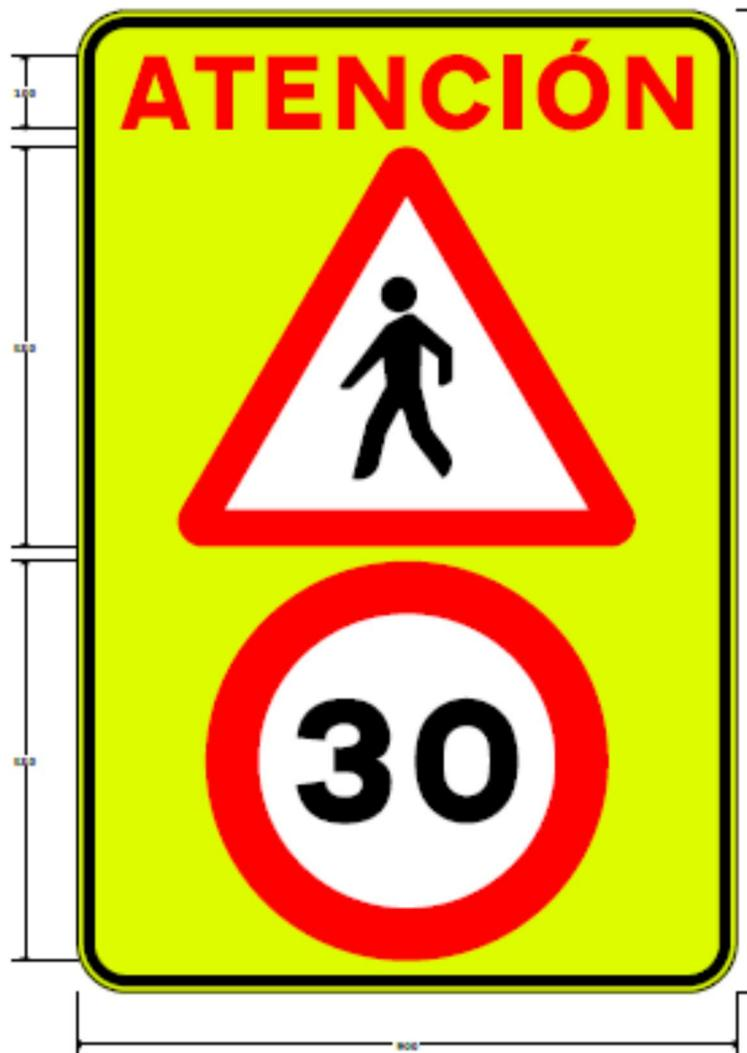
Se utiliza como primer preaviso de plataforma elevada (la más lejana al elemento) para indicar precaución por la presencia de peatones y con limitación de velocidad máxima a 30 km/h. Será reflectante nivel III (DG) y fondeada en amarillo limón, con cantos pintados color amarillo.
