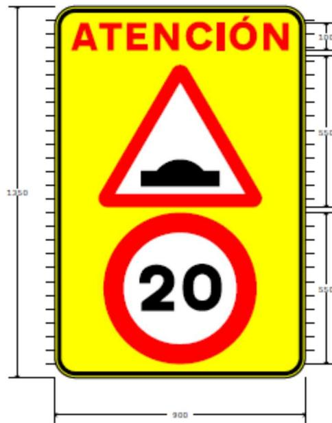
Señal de preaviso SEGUNDA de 600x900 mm reflectante DG (nivel III) Amarillo limón, con las señales tipo R-301 (20) y P-15a (RESALTO)..
